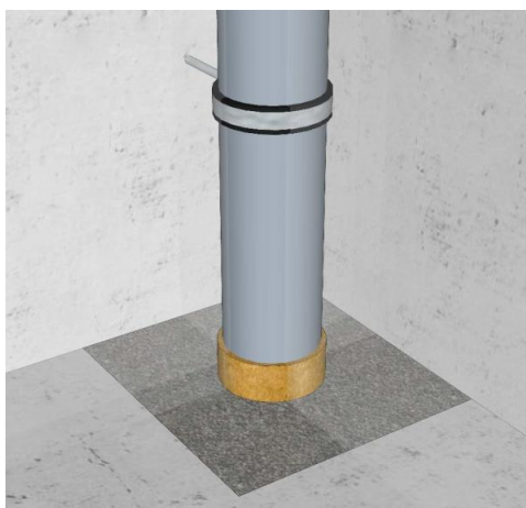
Figure 12 – Désolidarisation des descentes d'eau par collier antivibratile et fourreau résilient, avant rebouchage de la réservation en plancher (source : Guide Qualitel Acoustique)
